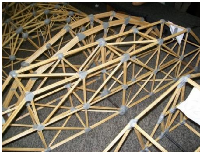
Figura 1: Esquema de emenda dos palitos de churrasco (imagem ilustrativa)
